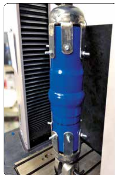
Figure 1. Échantillon testé jusqu'à la rupture. L'embout mâle s'est cassé à l'intérieur du joint.
