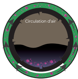
Répartition des effluents sur toute la longueur des conduites par capillarité
